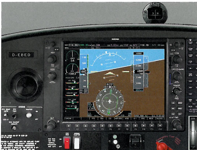
Abb. 4: Bei 9,2 DME leitet man eine Rechtskurve zur Anfluggrundlinie ein. Der Localizer wird mit 30 bis 45 Grad unter dem Glidepath angeschnitten und stets zuerst erflogen. Zur Unterstützung beim Einkurven nutzen wir die Peilung des ZBN NDB
