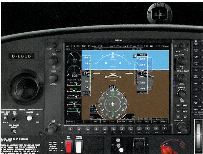
Abb. 5: Beim Überflug des Voreinflugzeichens (Outer Marker) wird die Sollflughöhe von 2450 Fuß QNH geprüft. Die ILS-LOC- und GP-Anzeige sowie die ADF-Peilung entsprechen dem Anflugprofil
