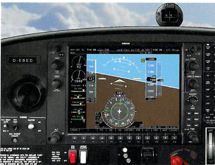
Abb. 3: Kurz vorm IAF (Initial Approach Fix) ZWN VOR/DME geht's mit einer Linkskurve weiter auf dem Radial 020. Wir leiten jetzt den Sinkflug auf 4000 Fuß QNH ein – unsere Anflughöhe
