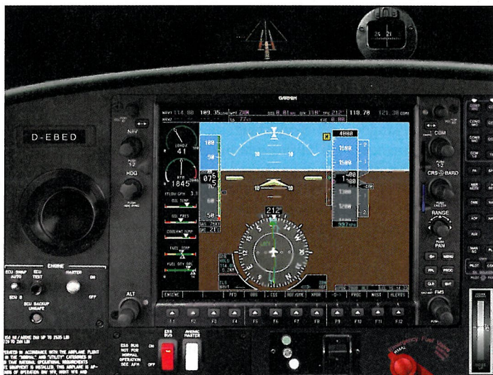
Abb. 6: Wenige Fuß über der Entscheidungshöhe kommt die Landebahn zum Vorschein. Die Geschwindigkeit wird bis zum Überflug der Schwelle auf V_{ref} plus Gustfaktor angepasst
