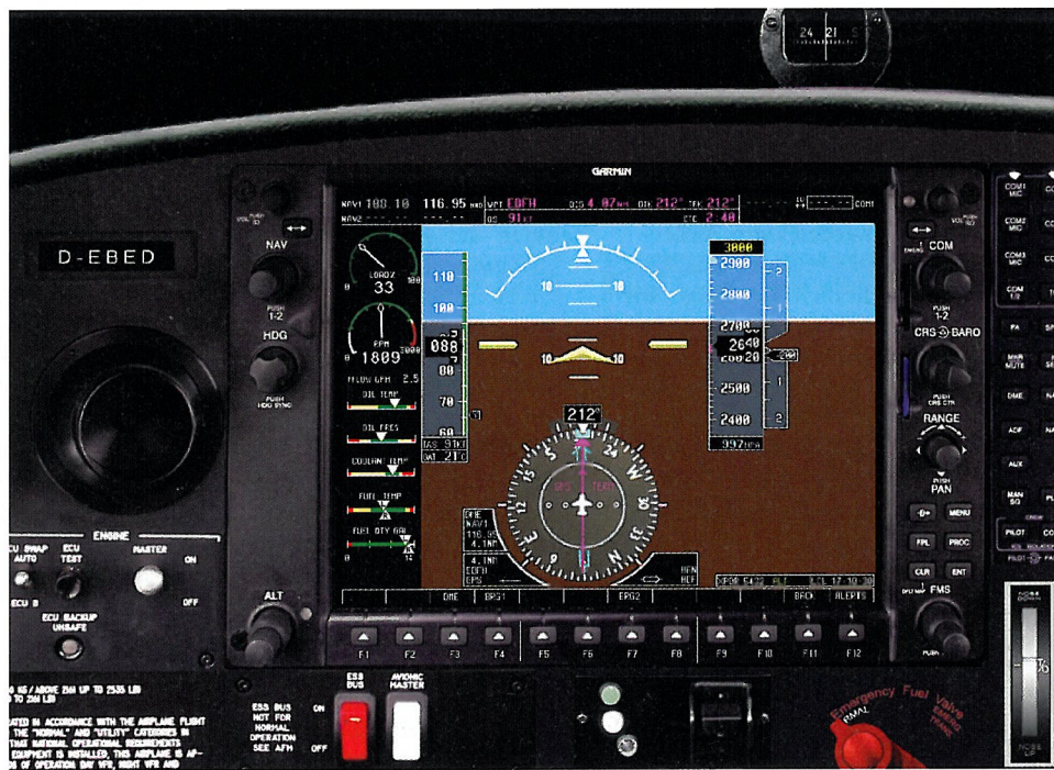
Beispiel 3 GPS/NDB-Anflug auf die »21« in Frankfurt/Hahn (EDFH): Die magentafarbene CDI-Nadel dient als GPS-Kursführung zur Piste 21 in einer Korridorbreite von plus/minus 0,3 Nautischen Meilen. Alle zugehörigen GPS-Angaben sind – ebenfalls magentafarben – in der Box überm Horizont zu finden. Die blaue Doppelnadel zeigt das QDM zum HAN NDB. Die Kennungsangaben stehen in der Box rechts unten neben dem Kurskreisel. In der linken oberen Ecke des Displays stehen immer die Frequenzen von NAV 1 und NAV 2, links die Standby-Frequenz, rechts hervorgehoben die aktive
