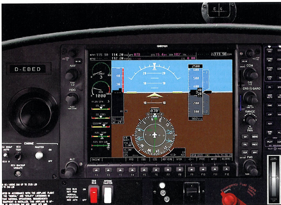
Beispiel 1 Abflugbereit auf der Piste 07 des Frankfurter Airports (EDDF): Die grüne Nadel im CDI-Mode ist als NAV 1 auf das Radial 070 vom FFM VOR/DME eingestellt. DME-Entfernung dazu und Frequenz stehen in der linken oberen DME-Box neben dem Kurskreisel. Die blaue Einfachnadel im GPS-Mode zeigt das QDM zum RID VOR/DME an. Entfernung, Kennung, Mode und Zeigersymbol sind in der Box links unten neben dem Kurskreisel dargestellt. Weitere Informationen stehen im oberen GPS-Datenfeld überm Horizont. Die blaue Doppelnadel als NDB-Anzeige weist auf das EH NDB (Egelsbach). Angaben dazu in der Box rechts unten neben dem Kurskreisel
