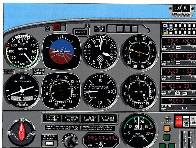
5 Der Heading Bug steht auf 041 Grad, dem ILS-Anschneidewinkel
