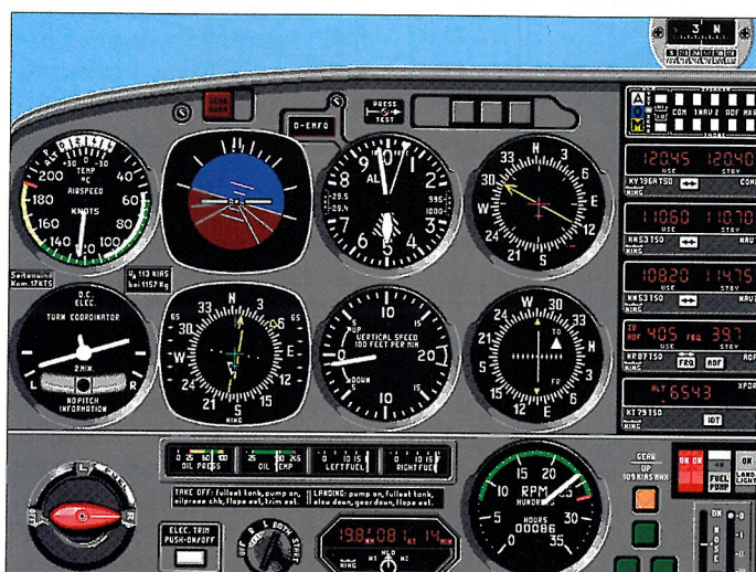
3 QDM von 360 Grad, die Nadel am NAV1 mittig, wir kreuzen das ILS
