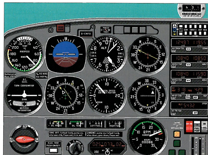
2 Langsam läuft das Radial 177 ein, das ADF peilt bereits AUG NDB
