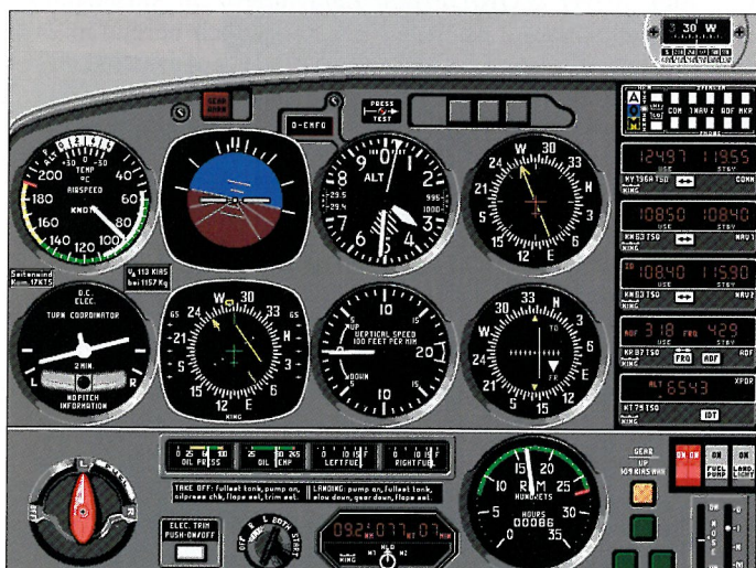
5 Der CDI am HSI läuft langsam ein, sodann kurven wir auf 250 Grad
