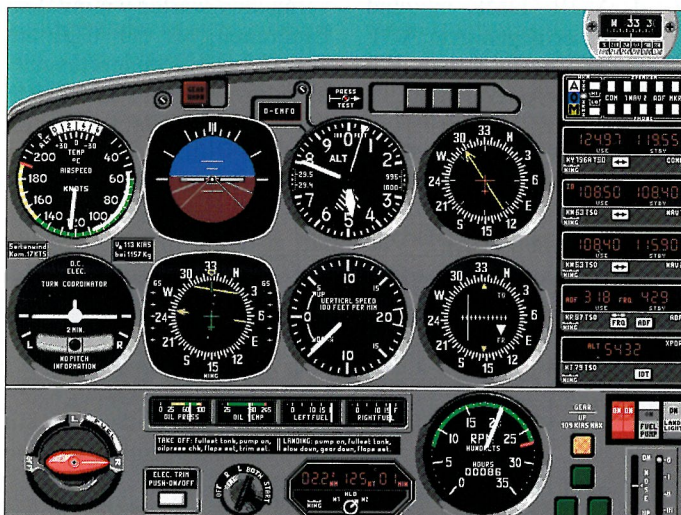
3 Auf Radial 333 outbound MAH VOR/DME sinken wir auf 3500 Fuß QNH
