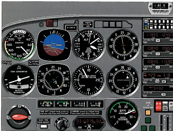
1 Nach 3.0 DME OBI kurven wir nach rechts in Richtung Radial 177
