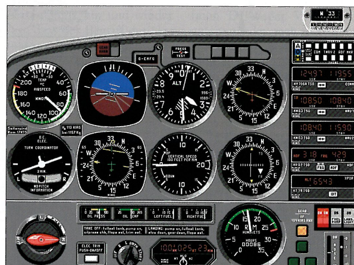
4 Wir kurven nach links, um den Localizer mit 30 Grad anzuschneiden
