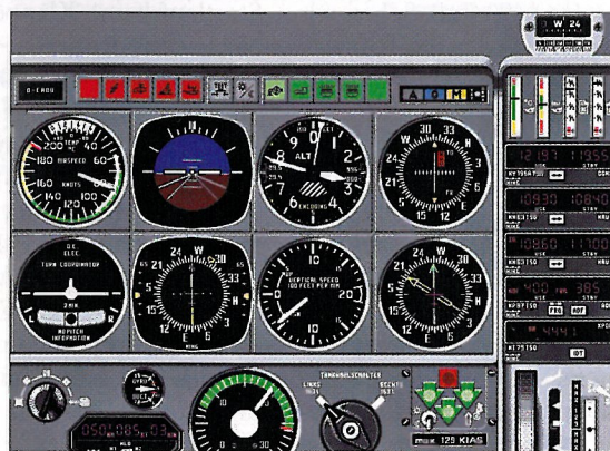
7 Am OM korrekte Höhe: Der Höhenmesser zeigt 2800 Fuß
