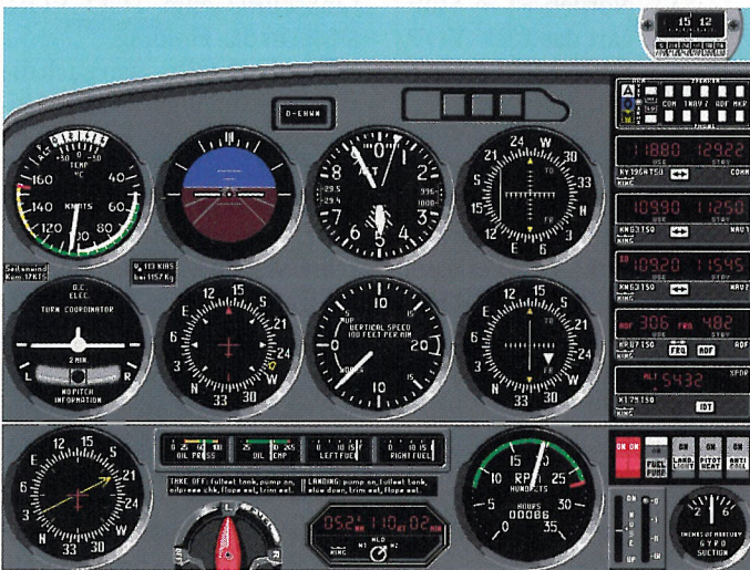
3 Bereits im Sinkflug: Das ADF zeigt ein QDM von 205 Grad zum SU NDB
