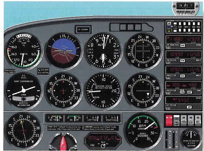
2 Das ADF peilt das SG NDB; am NAV 1 ist die ILS-Frequenz gerastet
