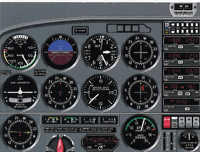
5 Höhenmesser-Check: Am Outer Marker sollten wir in 2430 Fuß fliegen
